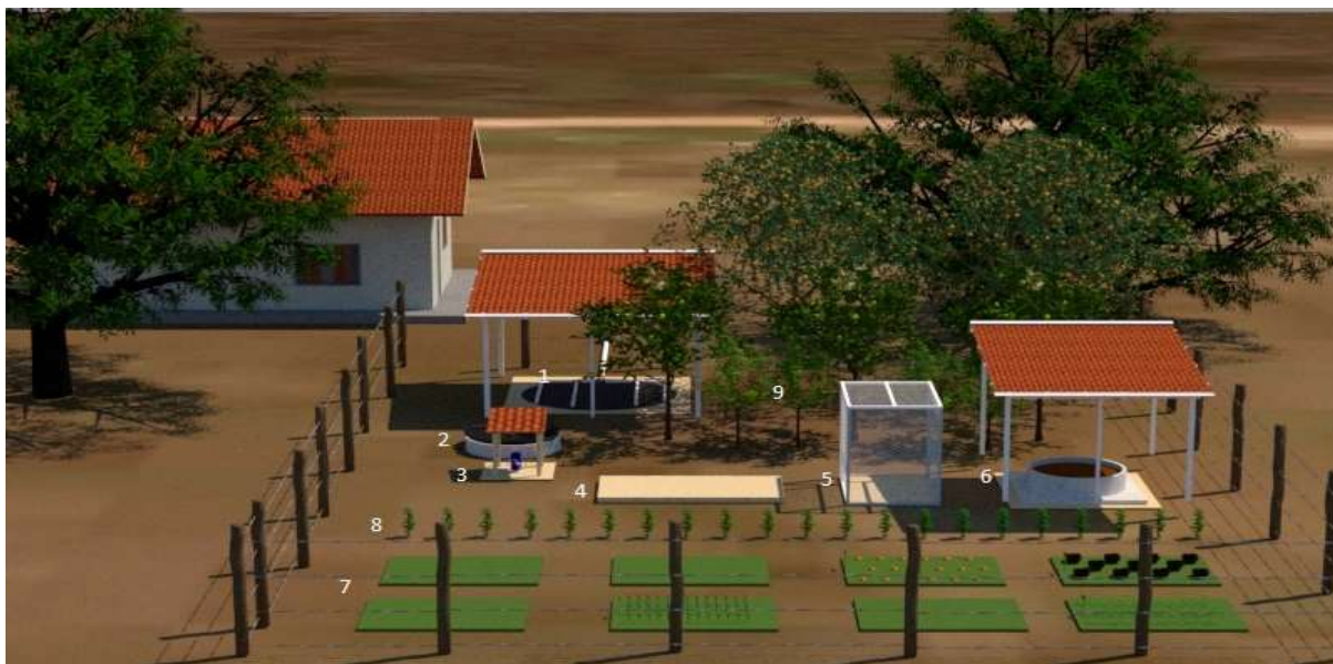
Figura 01 – Visão geral do sistema de reúso de águas cinza implantado pelo Projeto São José/SDA e os seus componentes ( 1 – Filtro Biológico; 2 – Tanque de reúso; 3 – Eletrobomba; 4 – Compostagem; 5 - Minitelado; 6 – Minhocário; 7 – Canteiros de hortaliças; 8 – Linhas de Hortaliças tipo fruto; e, 9 – Linhas de frutíferas) 4 .
